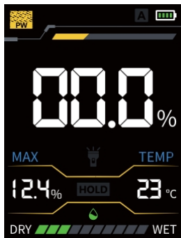
Режим на изпитване на гипсова стена
