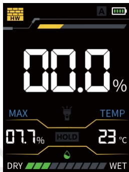
Режим на изпитване на бетонна стена
