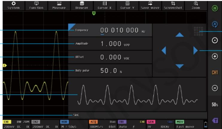
Lišta pro nastavení frekvence, můžete nastavit frekvenci na 0~50 MHz.
