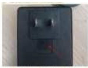
4.1.2 Vstavite nov napajalni vtič in ga potisnite navznoter. Novi vtič se zaskoči, ko zaslišite zvok "klik".
